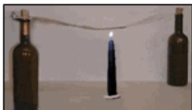
Όταν τοποθετήσεις το αναμμένο κερί κάτω από το μεταλλικό σύρμα, όπως στο διπλανό πείραμα, τι θα παρατηρήσεις στο σχήμα του σύρματος; Γιατί;
